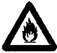
Matières inflammables ou haute température (1)
