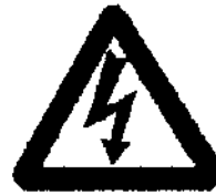
Gevaar voor elektrische spanning
