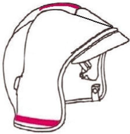
2.2 La bande circulaire est placée à une distance de la partie inférieure de la calotte comprise entre 10 et 100 mm. Lorsqu'il y a deux bandes, la distance intermédiaire est comprise entre 10 et 25 mm.
