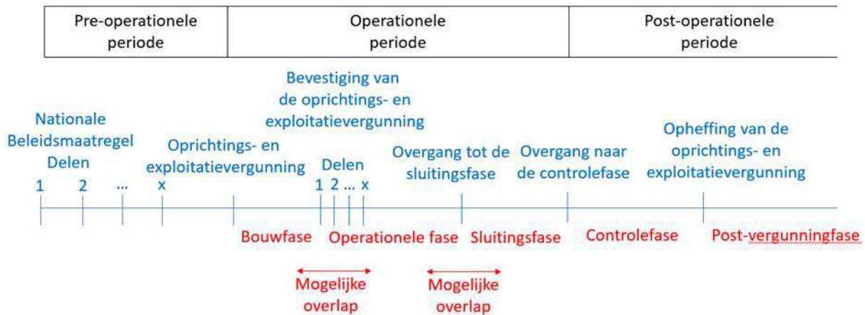
Fig. 1: Perioden en fasen van de berging aan de oppervlakte van radioactief afval
